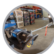
TESTET 1200+ GANGER TREKKSTANGAVE MED MAKS. LAST.
